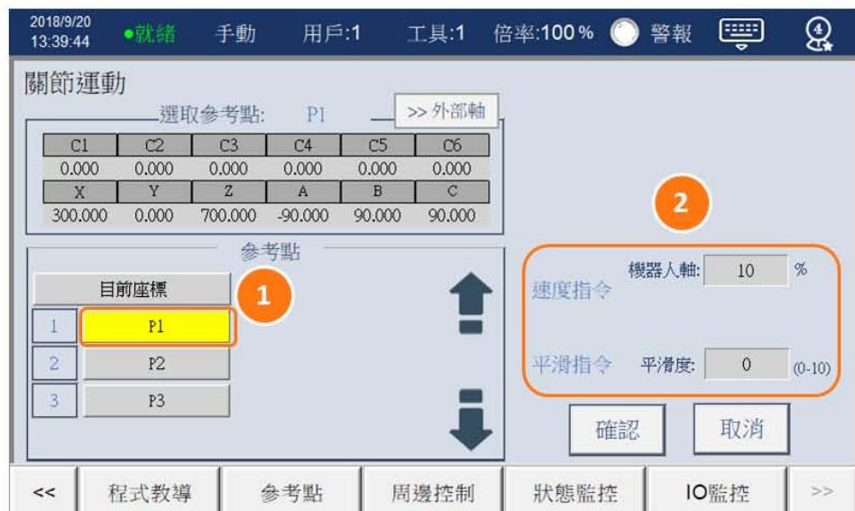
3. 設定完指令後，按下確認後，可看到程式編輯頁面如下圖。其內容意義：起始點為上一單節結尾；結束點為P1。機器人軸關節速度10%進行速度規劃。軌跡平滑程度為0。
