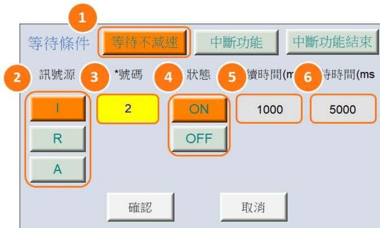
7. 条件设立後按下確定，則可看到程式編輯頁面下圖所示。其內容意義為：當I2的訊號持續輸入超過1秒(CT=1000ms)時，判斷I2訊號成立，手臂運動不減速。而目前單節運動完後5000ms內I2的訊號沒有持續輸入超過1秒(CT=1000ms)，則會直接繼續下一單節，但S331會ON。
