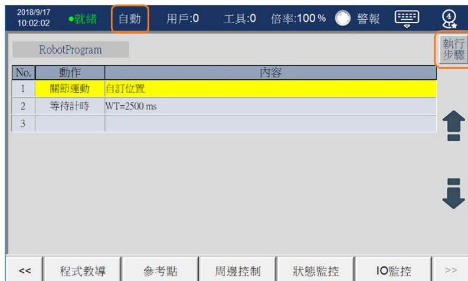
2. 點取执行步骤後，弹出一动作执行视窗，如下图所示。可以直接执行：移动指令、料盘、M码、周边控制、输入输出、副程式。
