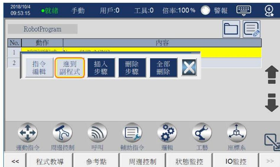
5. 進入副程式後，橘框內出現"RobotProgram"與"SUB\_2"，其中"SUB\_2"平貼於頁面，表示目前程式屬於"SUB\_2"，因此在該頁面進行任何動作將儲存於SUB\_2副程式；而"RobotProgram"為浮紐，表示RobotProgram位於SUB\_2上層，若點擊該浮紐即可回到RobotProgram程式。
