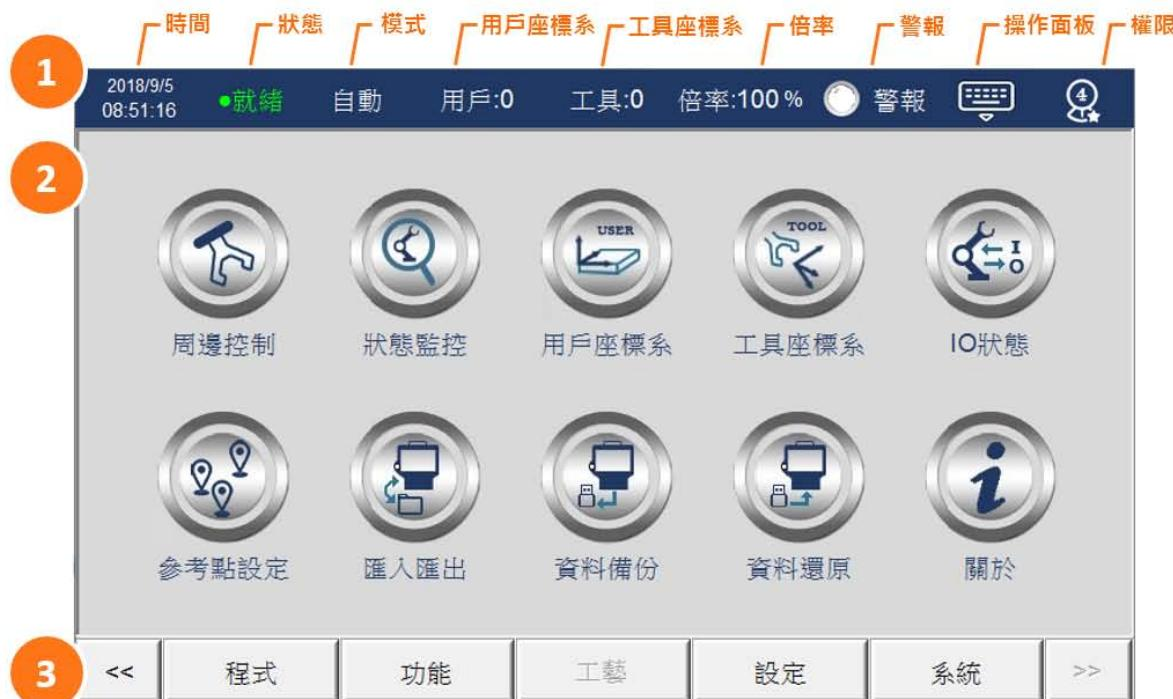
1. **狀態列**：顯示訊息由左往右依次為：日期時間、控制器狀態、模式、用戶座標系、工具座標系、倍率、警報、操作面板與權限。
