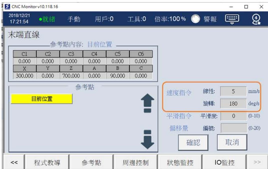
以 SCARA (X, Y, Z, C) 為例，空間中有3點，P1點座標=(500, 250, 200, 0)，P2點座標=(500, 290, 200, 40)，P3點座標=(520, 290, 200, 120)：
