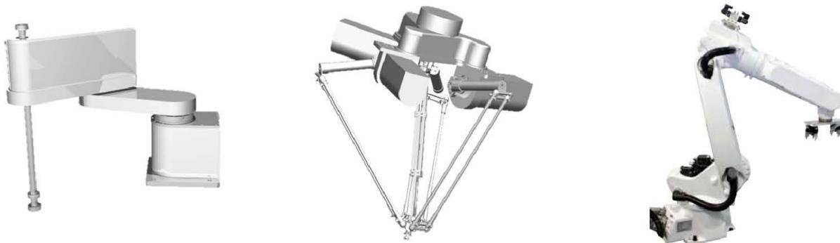
除了最常见的这3种手臂，更有许多变型的机器手臂，由关节机构加上直线机构组合而成，用於冲床取放、注塑机取放、打磨等应用，新代不仅致力於一般泛用型手臂控制的开发和改进，对於各种产业的专用机器手臂同样是持续在不断与客户合作新需求，如下图展示各种变型手臂。详细的各機種資訊，可参考[机器人种类与规格<sup>3</sup>](#)。
