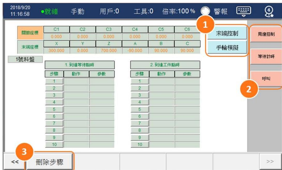
1. 「**控制模式**」按鈕：切換末端控制或手輪模擬模式。
