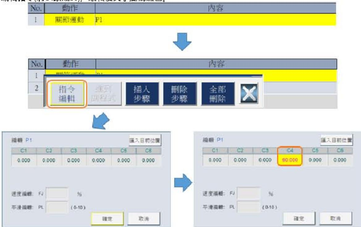
4. 条件设立后按下确定，则可看到程式编辑页面如下图所示。由於改变座標内容(座標值、座標系设定)，因此指令列的内容由原本的参考点(P1)变成自订位置。
