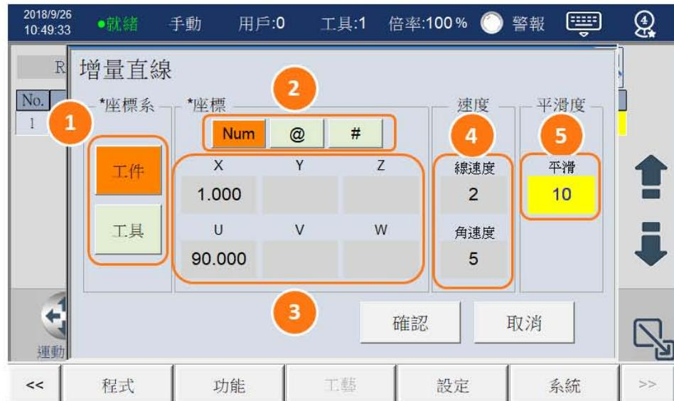
6. 条件设立後按下確定，可看到程式编辑页面如下图所示。在工件座標系下(OBJ)，末端增量距离為：X=1 (mm)，末端增量旋转角度為A=90 (deg)，末端直線速度為2mm/s(FL=2)，末端旋轉速度為5deg/s(FR=5)，軌跡平滑程度為10。
