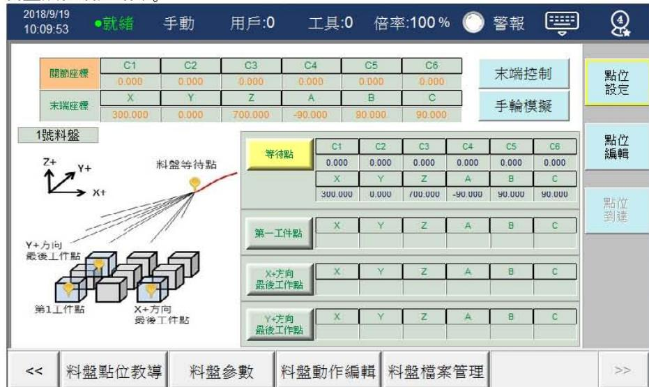
5. 其它如第一工件点、X+方向最後工件点、Y+方向最後工件点也是同样的设定方式。
