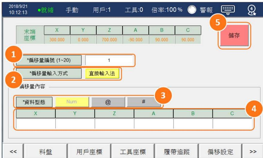
1. 「偏移量編號」：輸入欲設定的偏移量編號，若該組偏移量已設定過，輸入編號後會自動顯示該組內容。
