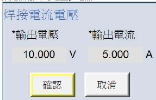
3. 完成參數設置後按下確認，即可看到程式編輯頁面呈現如下圖所示資訊。其內容意義：控制焊機輸出電流5A、電壓10V
