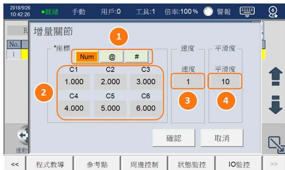
5. 条件设立後按下確定，則可看到程式編輯頁面如下圖所示。其內容意義：各軸關節增加移動角度(C1=1；C2=2；C3=3；C4=4；C5=5；C6=6)，單軸速度百分比為1，軌跡平滑程度為10。
