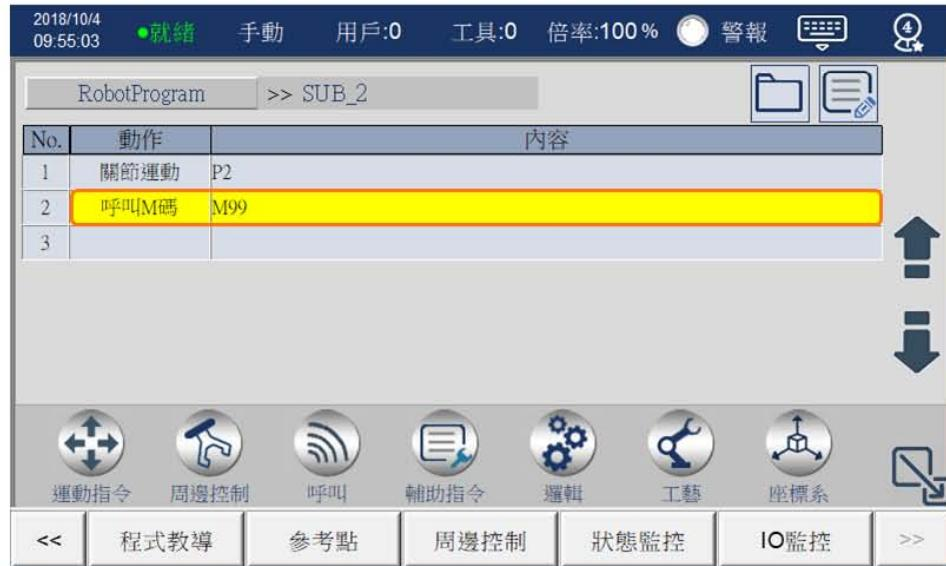
8. 編輯完副程式(SUB\_2)指令後，按下"RobotProgram"浮紐，回到主程式頁面。此時即完成呼叫副程式(SUB\_2)。
