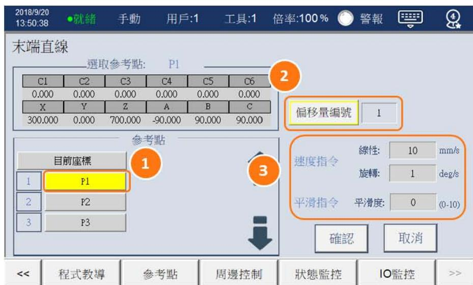
4. 設定完指令後，按下確認後，可看到程式编辑页面如下图。其內容意義：起始點為上一單節結尾；結束點為P1。世界座標系(USER=0)、法蘭面座標(TOOL=0)的狀態下，末端直線速度10mm/s、旋轉速度1deg/s進行速度規劃。軌跡平滑程度為0。偏移量編號為1(OFS=1)。
