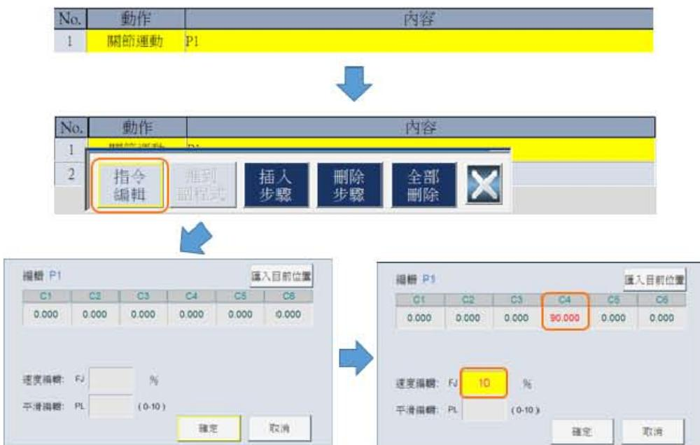
4. 条件设立後按下確定，則可看到程式編輯頁面如下圖所示。由於改變座標內容(座標值、外部軸設定)，因此指令列的內容由原本的參考點(P1)變成自訂位置。同時FJ改成10%。
