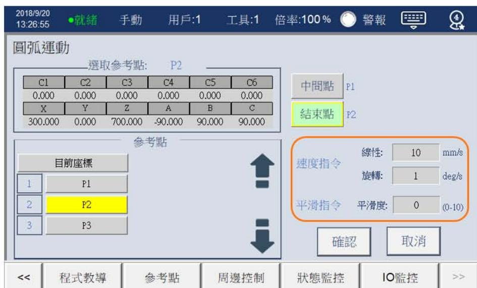
4. 設定完指令後，按下確認後，可看到程式編輯頁面如下圖。其內容意義：起始點為上一單節結尾；中間點為P1；結束點為P2。世界座標系(USER=0)、法蘭面座標(TOOL=0)的狀態下，末端直線速度10mm/s、旋轉速度1deg/s進行速度規劃。軌跡平滑程度為0。
